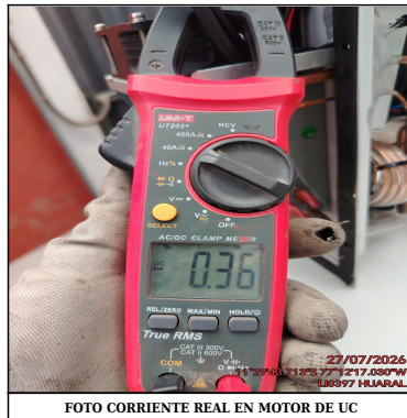
FOTO CORRIENTE REAL EN MOTOR DE UC
