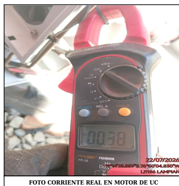
FOTO CORRIENTE REAL EN MOTOR DE UC
