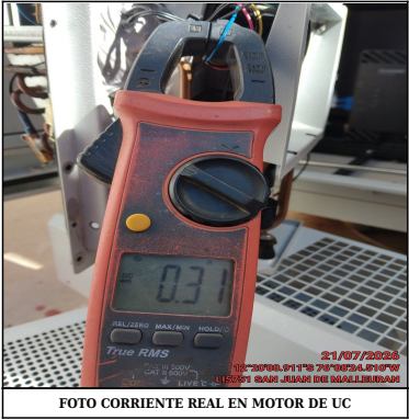
FOTO CORRIENTE REAL EN MOTOR DE UC
