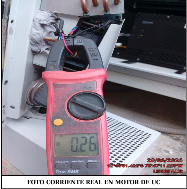
FOTO CORRIENTE REAL EN MOTOR DE UC
