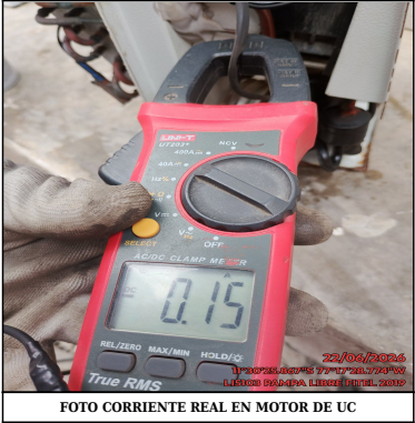
FOTO CORRIENTE REAL EN MOTOR DE UC
