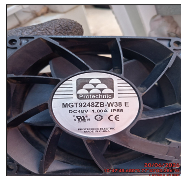
FOTO CORRIENTE SEGUN PLACA EN MOTOR VENTILADOR
