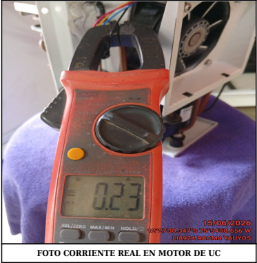
FOTO CORRIENTE REAL EN MOTOR DE UC
