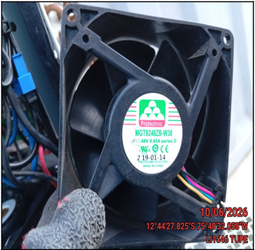
FOTO CORRIENTE SEGUN PLACA EN MOTOR VENTILADOR
