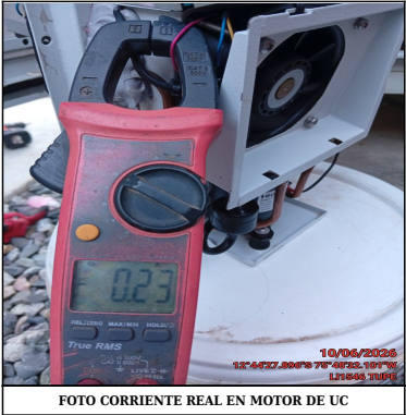
FOTO CORRIENTE REAL EN MOTOR DE UC
