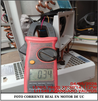
FOTO CORRIENTE REAL EN MOTOR DE UC
