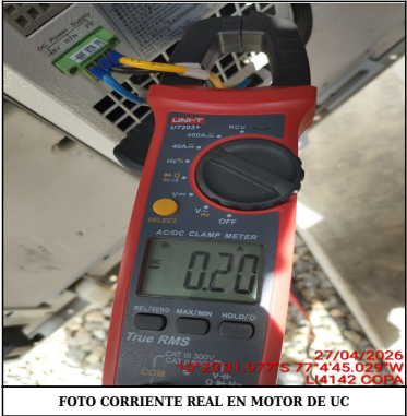
FOTO CORRIENTE REAL EN MOTOR DE UC
