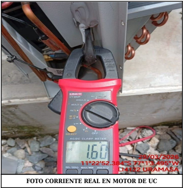
FOTO CORRIENTE REAL EN MOTOR DE UC
